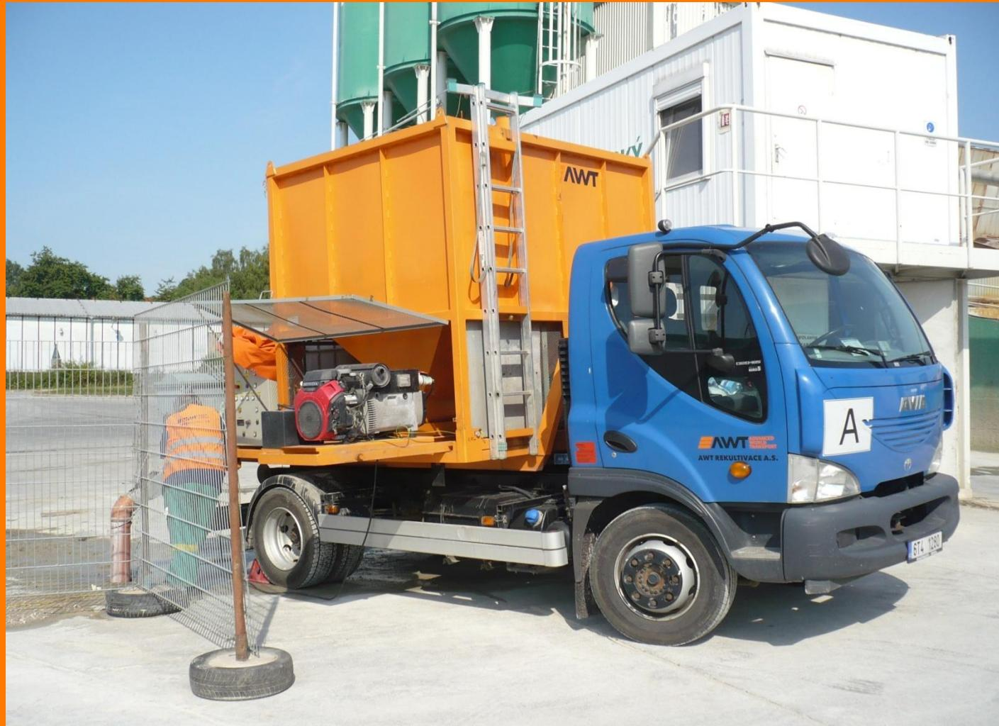
Použití mísící stanice BAMAmix umožňuje provádění zásypů i v místech špatně přístupných pro těžkou techniku a zajišťuje snížení spotřeby záměsové vody.
